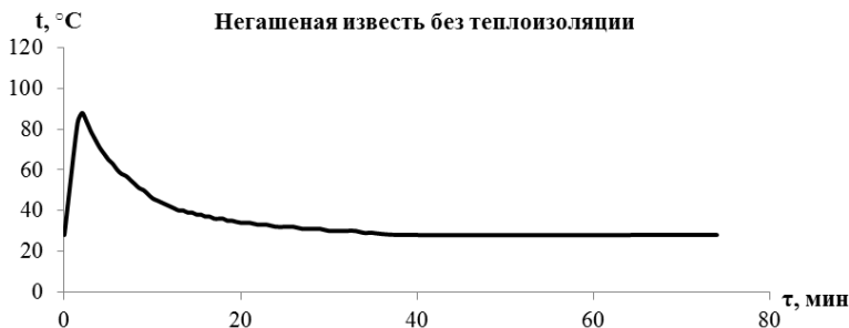
Рис. 4. Зависимость температуры нагрева от времени смеси на основе гашеной извести без теплоизоляции
